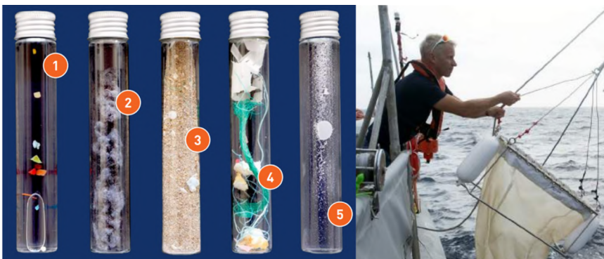
Figure 34. Échantillonnage de l'eau douce à l'aide d'un filet manta – (TARA, 2020)
