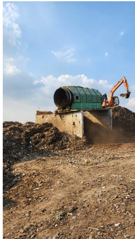
Tri mécanique de la fraction organique des déchets (refus qui sortent du trommel et composte en dessous)
