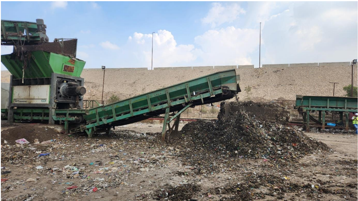
Machine triant et broyant les déchets pour en faire du CSR
